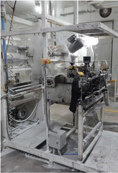
Eletrodo com solda térmica e sistema de guilhotina:
